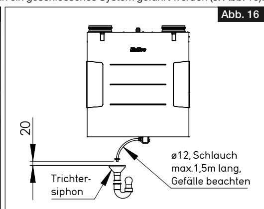
6. Kondensatschlauch (Länge max. 1,5 m) an das Entwässerungssystem des Gebäudes anschließen (s. Abb. 17).
