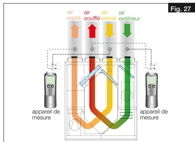
2. À l'aide du logiciel easyControls ou de la commande KWL-BE Touch, sélectionner les différents profils de ventilation : Absent: 30 % / Présent: 50 % / Forcé : 80 % (voir Fig. 28).
