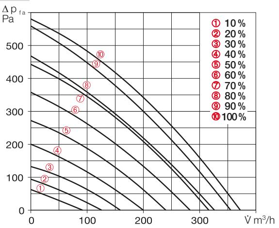
**Détermination des courbes caractéristiques du système pour le soufflage et l'extraction d'air :**
