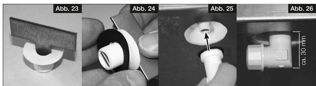
12. Kondensatschlauch DN 12 mm (nicht im Lieferumfang) auf den Schlauchverbinder des Siphon-Gehäuses aufstecken und von Hand festschrauben.
