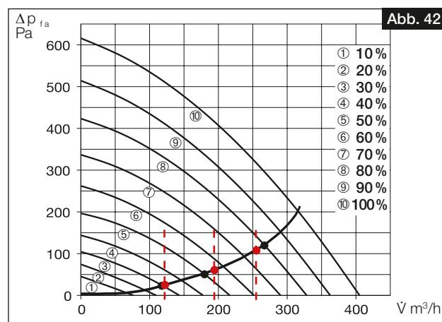
2. An den Schnittpunkten der Volumenströme mit der Anlagenkennlinie können nun näherungsweise die einzustellenden Ventilatorleistungen (in %) der Lüftungsprofile abgelesen werden. Diese über die Software easyControls 3.0 oder das Bedienelement KWL-BE Touch in das entsprechende Lüftungsprofil eintragen (vgl. Abb. 42 und Abb. 43).
