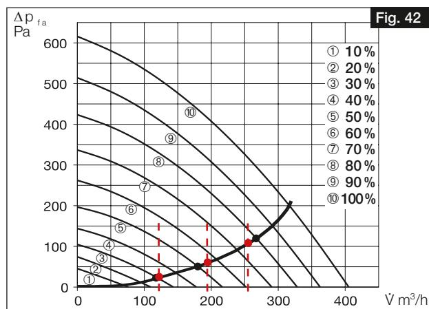
2. À l'intersection des débits volumiques avec la courbe caractéristique du système, les performances du ventilateur à régler (en %) du profil de ventilation peuvent être lues approximativement. Il convient de les saisir dans le profil de ventilation correspondant à l'aide du logiciel easyControls ou de la commande KWL-BE Touch (voir Fig. 42 et Fig. 43).
