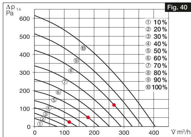
6. Si les différents points de mesure sont connectés, la courbe caractéristique du système pour l'air soufflé ou extrait est générée (voir Fig. 40).
