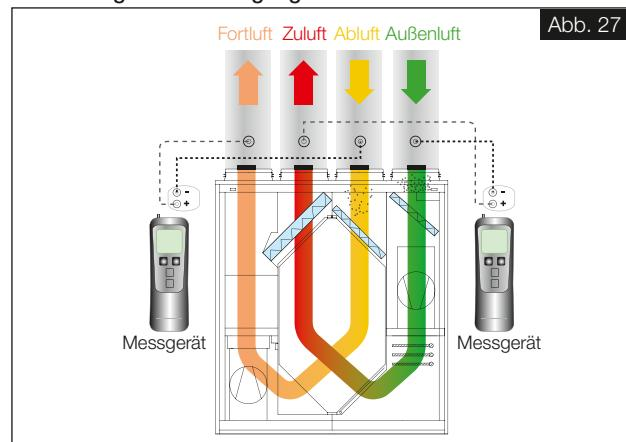
2. Über die Software easyControls 3.0 oder das Bedienelement KWL-BE Touch für die Ventilatorleistungen folgende Werte im jeweiligen Lüftungsprofil hinterlegen: Unterwegs: 30 % / Zuhause: 50 % / Intensivlüftung: 80 % (vgl. Abb. 28).
