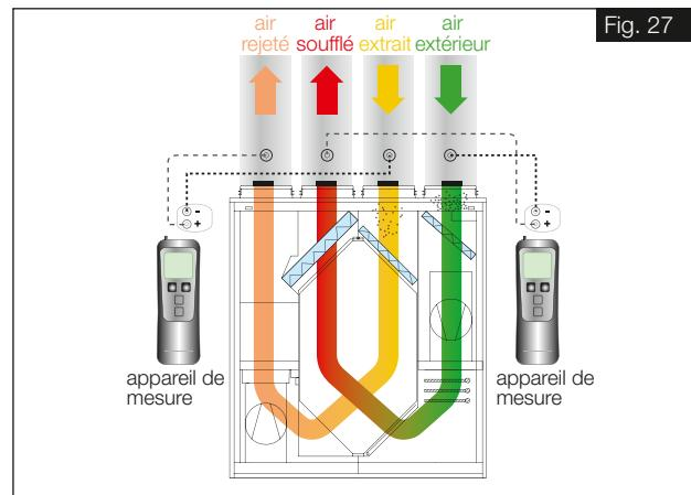
2. Utiliser le logiciel easyControls 3.0 ou la commande KWL-BE Touch pour enregistrer les valeurs suivantes pour les vitesses des ventilateurs dans le profil de ventilation correspondant : **Absent** : 30 % / **Présent** : 50 % / **Forcé** : 80 % (voir Fig. 27).
