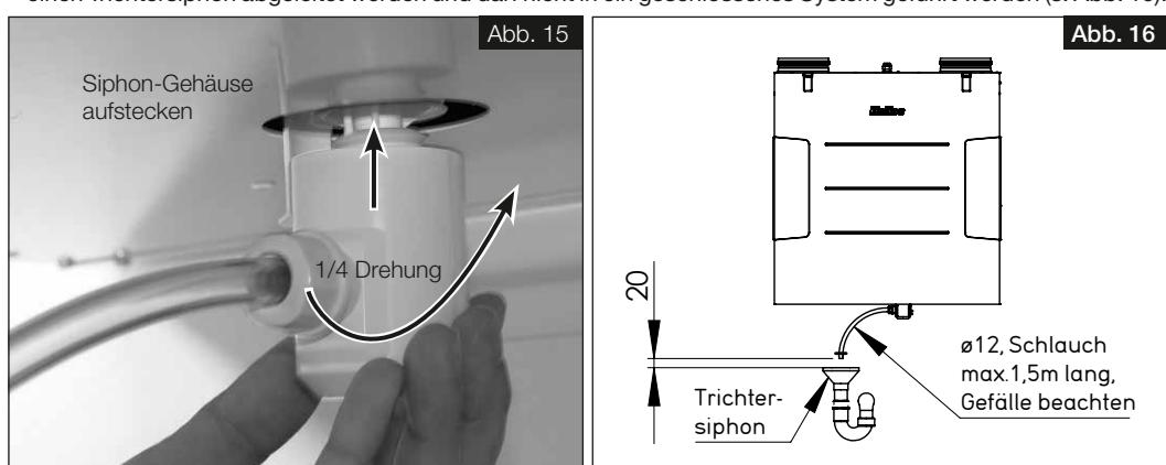
6. Kondensatschlauch (Länge max. 1,5 m) an das Entwässerungssystem des Gebäudes anschließen (s. Abb. 17).
