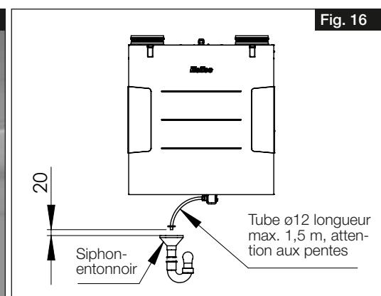
6. Raccorder le tube des condensats (longueur max. 1,5 m) au système d'évacuation des eaux usées du bâtiment (à un siphon) (voir Fig. 17).
