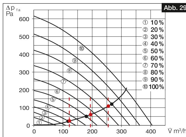
2. An den Schnittpunkten der Volumenströme mit der Anlagenkennlinie können nun näherungsweise die einzustellenden Ventilatorleistungen (in %) der Lüftungsprofile abgelesen werden. Diese über die Software easyControls 3.0 oder das Bedienelement KWL-BE Touch in das entsprechende Lüftungsprofil eintragen (vgl. Abb. 29 und Abb. 30).
