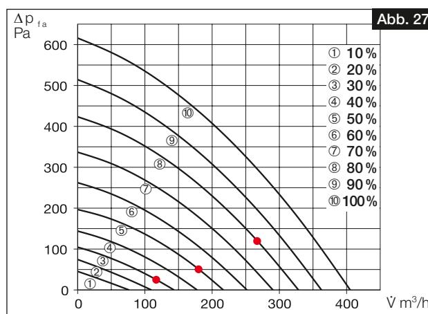
6. Werden die einzelnen Messpunkte verbunden, entsteht die Anlagenkennlinie für Zu- bzw. Abluft (vgl. Abb. 28).
