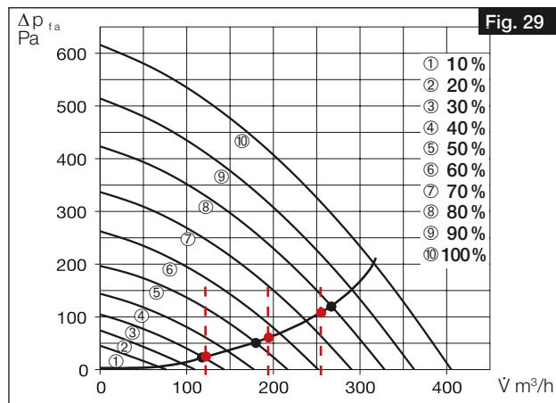
2. À l'intersection des débits volumiques avec la courbe caractéristique du système, les performances du ventilateur à régler (en%) du profil de ventilation peuvent être lues approximativement. Il convient de les saisir dans le profil de ventilation correspondant à l'aide du logiciel easyControls ou de la commande KWL-BE Touch (voir Fig. 29 et Fig. 30).
