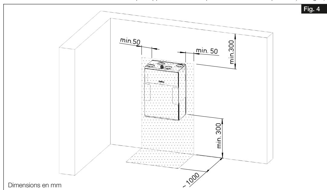
1. L'installation ne doit être effectuée que dans des locaux hors gel, en raison du risque de givre. La température ambiante ne doit pas descendre en dessous de +5 °C.
