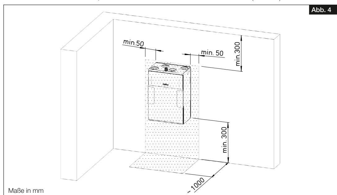
1. Die Aufstellung darf nur in frostfreien Räumen erfolgen, da die Gefahr des Einfrierens besteht. Die Raumtemperatur darf nicht unter +5 °C absinken.
